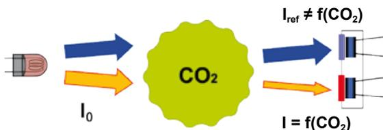
Une procédure d'ajustage en de multiple points de CO<sub>2</sub> et de température apporte une excellente précision de mesure sur toute la gamme de température.
