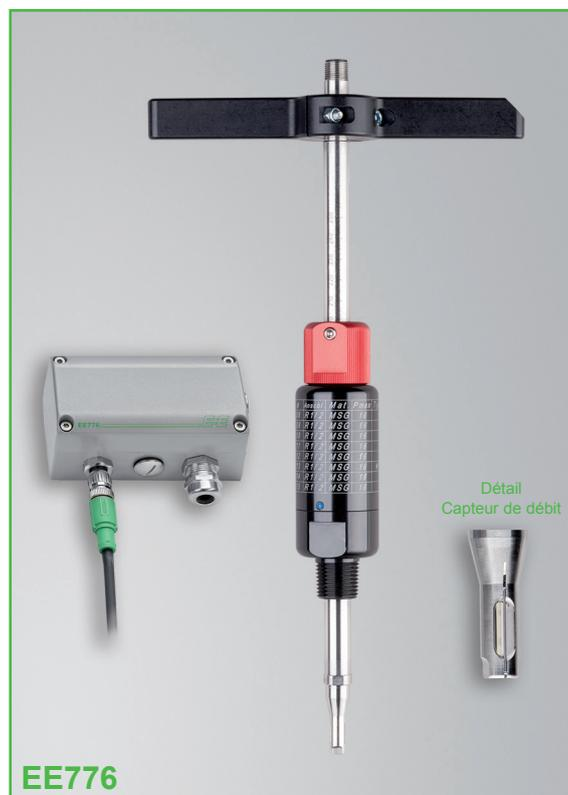
La grande justesse de mesure à 1.5% de la valeur mesurée est le résultat de l'étalonnage en usine orienté vers les applications clients, qui sont réalisés à 9 bar de pression. Pour une adaptation optimale aux différents travaux de mesure, on peut choisir entre deux gammes de mesure 0.2 ... 100Nm/s ou 0.2...200 Nm/s et trois longueurs de sonde différentes avec une profondeur d'insertion maxi de 165 / 315 / 465 mm.
