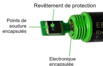
Capteur avec revêtement de protection et encapsulage
