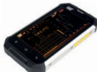
Quand le logiciel de journalisation est connecté à un pyromètre Cyclops, il enregistre des mesures de température instantanées chaque fois que le déclencheur du pyromètre est activé.
